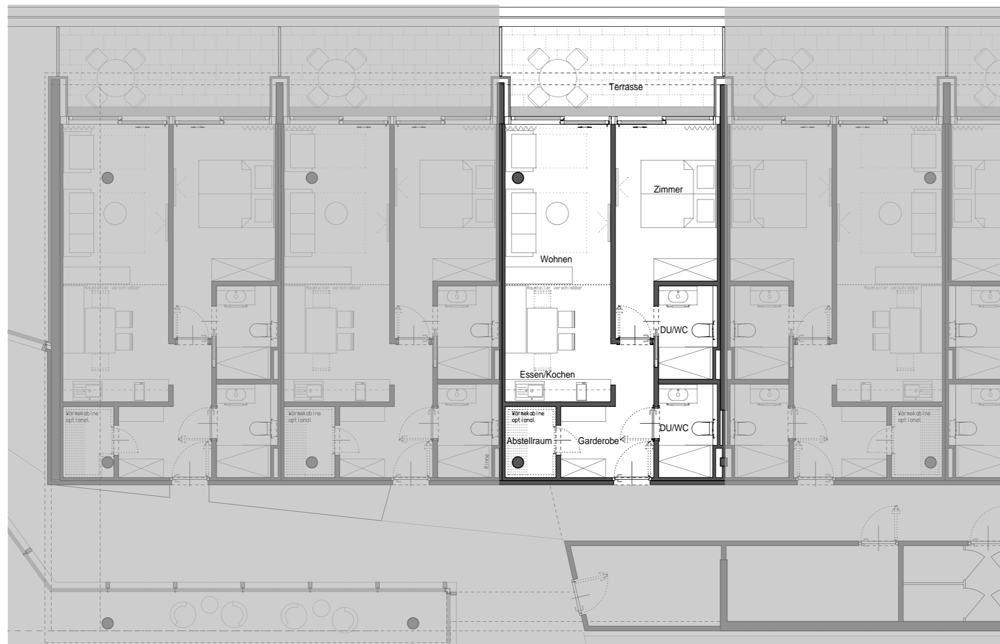
Grundriss Haus 3/Zwischentrakt E0 M 1:100
